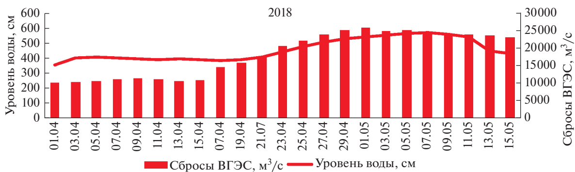
Рис. 5. Зависимость объемов сбросов ВГЭС от уровней воды, 2018 г.
