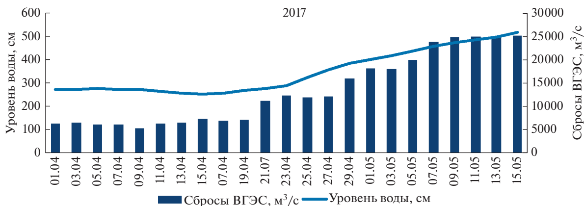
Рис. 4. Зависимость объемов сбросов ВГЭС от уровней воды, 2017 г.
