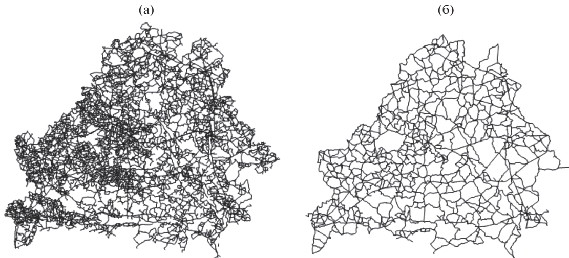
Рис. 2. Сеть автомобильных дорог Белоруссии: (а) исходная; (б) упрощенная (удалены дуги, обслуживающие малозначительные вершины).
