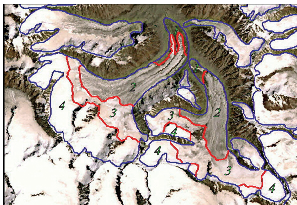
Рис. 1. Типы поверхности ледника: 1 — лед под сплошной мореной, im ; 2 — открытый лед, i ; 3 — старый фирн, f ; 4 — сезонный снег, ss . Синяя линия — граница ледника.
