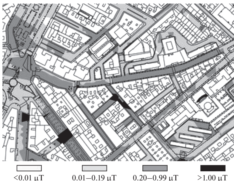
Рис. 1. Пример картографического представления результатов изучения техногенного магнитного поля в пределах улично-дорожной сети путем непрерывных замеров автоматизированным комплексом (Paniagua et al., 2007).
