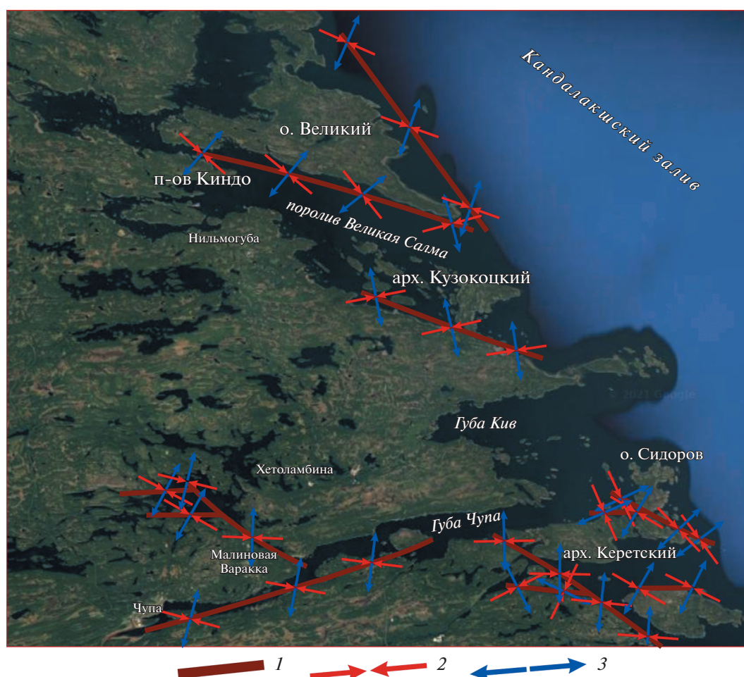
Рис. 6. Реконструкция положения главных осей напряжения с помощью структурно-геоморфологического метода (Сим, 1991) в программном обеспечении SimSGM. 1 – главные оси напряжения, 2 – оси максимального сжатия, 3 – оси максимального растяжения.
