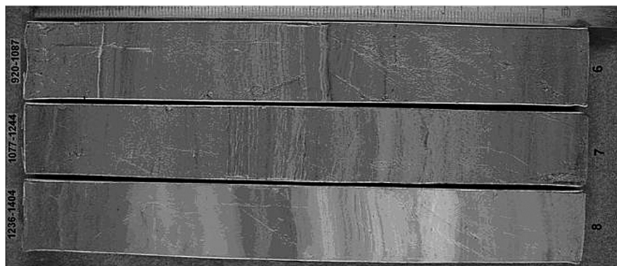
Рис. 2. Изготовление твердых препаратов из керна донных осадков.
